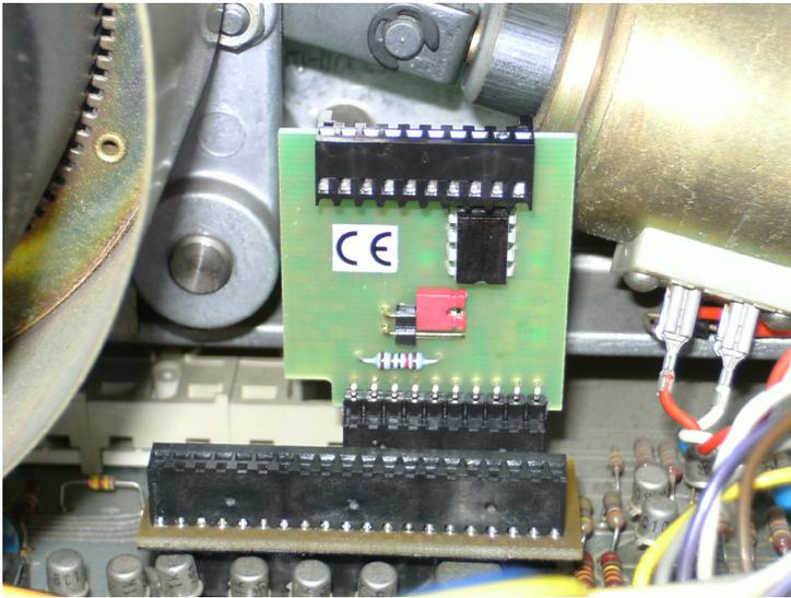
Dafür die Adapterplatine mit eingesteckter Pause Memory Platine (vorsichtig) einsetzen
